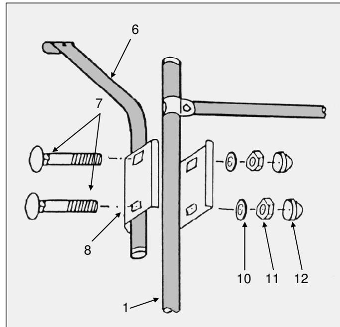
3.3. Stecken Sie die Gurthalter über die oberen Schloßschrauben und umschließen Sie die verbundenen Rohre mit den Klemmbacken (8) gem. Abb. und ziehen die Muttern (11) vorerst nur leicht an.
