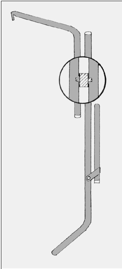
3.2. Der Fixierstift (F) ist werkseitig in die richtige Position eingepreßt. Die Lochposition sollte unter keinen Umständen verändert werden.
