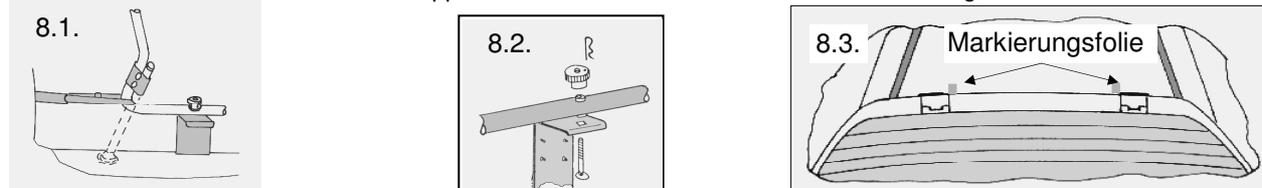
8.3. Die oberen Montageelemente können bei halb geöffneter Heckklappe ausgehängt werden.
