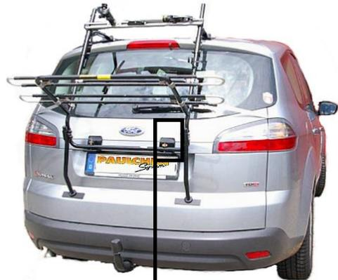
5. Jetzt werden die Muttern (11) an den Klemmbacken (8) fest angezogen. Die Muttern dürfen bis max. 11 Nm angezogen werden. Die Montageelemente sollen an der oberen Kante der Kennzeichenmulde anliegen (Siehe Abb. 5). Markieren Sie jetzt die Bohrpunkte und entfernen den Träger. Die markierten Löcher werden mit einem 2,5 mm Bohrer vorgebohrt.
