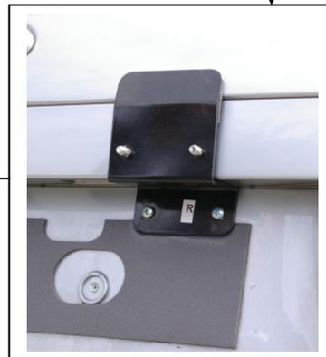
5.2. Setzen Sie jetzt die Aufsatzwinkel auf die Gewinde, schrauben Sie sie mit den selbstsichernden Muttern fest und stecken Sie die Schutzkappen auf die Muttern. **Der Aufsatzwinkel muss bei demontiertem Träger (insbesondere bei Benutzung einer Waschanlage) abgenommen werden.**
