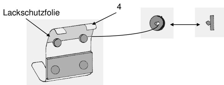
2. Hängen Sie die oberen Montageelemente (4) in die halb geöffnete Heckklappe ein. Der Abstand zwischen den Innenkanten der oberen Montageelemente muß 500 mm betragen. Siehe Abb.
