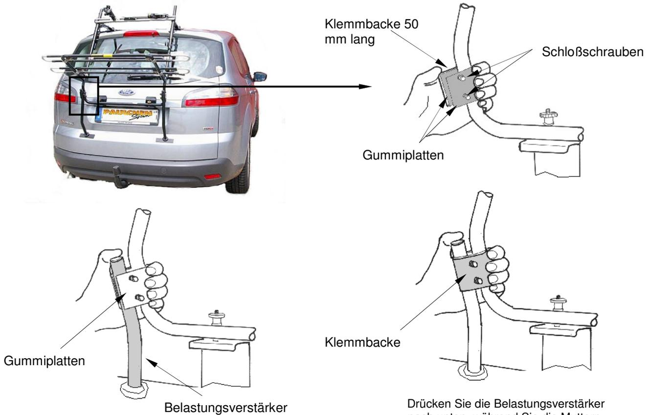
Drücken Sie die Belastungsverstärker nach unten, während Sie die Muttern an den Klemmbacken anziehen.
