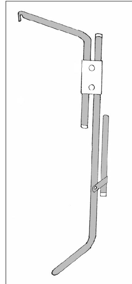
3.4. Die Trägerlänge ist jetzt fahrzeugspezifisch genau angepasst. Hängen Sie das Trägergestell (1) anschließend in die Aufnahme der oberen Montageelemente (4).
