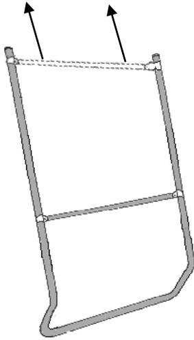
Entfernen Sie vormontierte Haltestrebe. Dazu lösen Sie die Schrauben an den Befestigungsschellen so weit, dass sie die Strebe nach oben abnehmen können.
