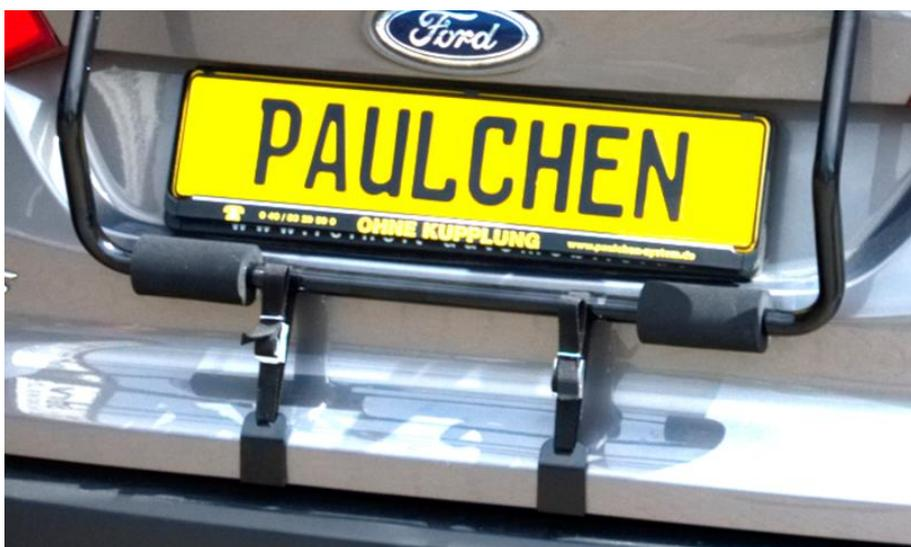
Verspannen Sie den Träger durch Anziehen der Gurte, bis der Träger eine feste Einheit auf der Heckklappe bildet.
