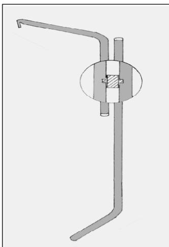
3.2. Der Fixierstift (F) ist werkseitig in die richtige Position eingepresst. Die Lochposition sollte unter keinen Umständen verändert werden.
