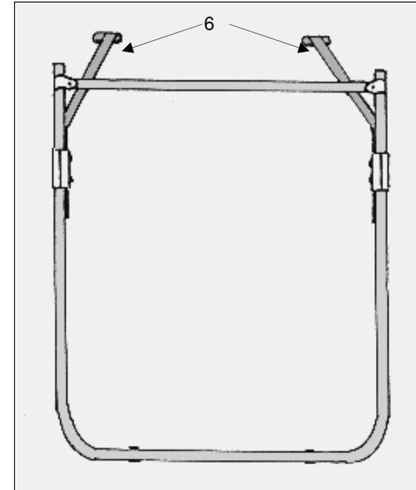
3.4. Die Trägerlänge ist jetzt fahrzeugspezifisch genau angepasst. Schwenken Sie die Tragarme (6) etwas nach innen ein und hängen Sie das Trägergestell (1) anschließend in die Aufnahme der oberen Montageelemente (4L/R) .
