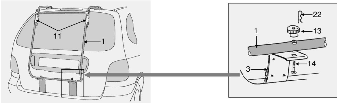
4. Befestigen Sie die Gummiformteile (24) an den unteren Montageelementen gem. Abb. und hängen Sie sie in die leicht geöffnete Heckklappe ein. Richten Sie die unteren Montageelemente (3) so aus, daß die Vierkantstanzungen der unteren Montageelemente (3) genau unter den Bohrungen des Trägerrohres liegen.
