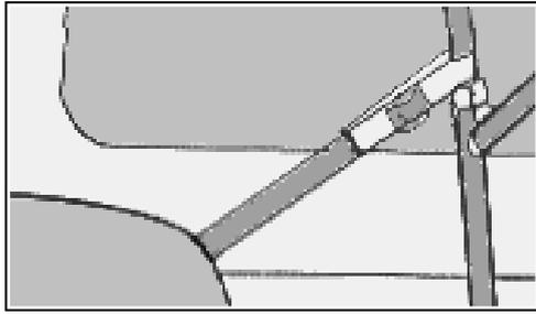
9.1. Lösen Sie die Spannung der Querlasthaltebänder und hängen Sie sie anschließend bei leicht geöffneter Heckklappe aus.
