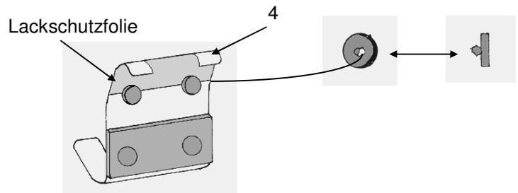
2. Hängen Sie die oberen Montageelemente (4) in die halb geöffnete Heckklappe ein. Der Abstand zwischen den Innenkanten der oberen Montageelemente muß \* mm betragen. Siehe Abb.
