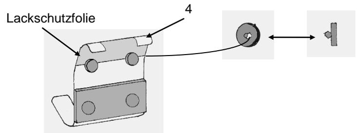
2. Hängen Sie die oberen Montageelemente (4) in die halb geöffnete Heckklappe ein. Der Abstand zwischen den Innenkanten der oberen Montageelemente muß 515 mm betragen. Siehe Abb.
