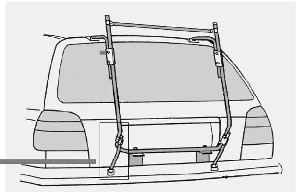
6. Befestigen Sie die Belastungsverstärker (5) gemäß Abbildung. Sie müssen fest auf der Stoßstange aufstehen. Bitte kleben Sie die Lackschutzfolien (26) unterhalb der Gelenkfüße im Bereich des Druckpunktes auf die Stoßstange.
