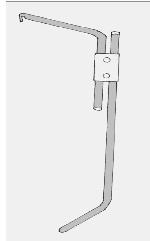
3.4. Die Trägerlänge ist jetzt fahrzeugspezifisch genau angepasst. Hängen Sie das Trägergestell (1) anschließend in die Aufnahme der oberen Montageelemente (4).
