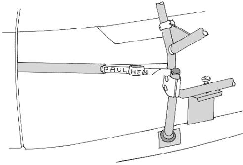
9.1. Lösen Sie die Spannung der Querlasthaltebänder und hängen Sie sie anschließend bei leicht geöffneter Heckklappe aus.
