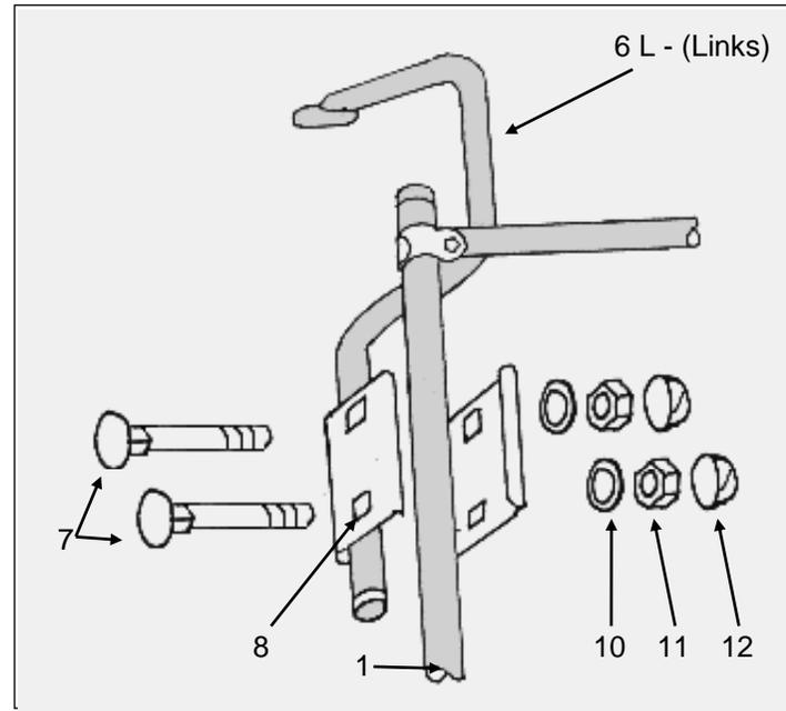
3.3. Danach umschließen Sie die verbundenen Röhre mit den Klemmbcken (8) gem. Abb, und ziehen die Muttern (11) vorerst nur leicht an.
