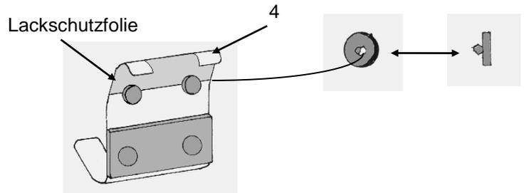
2. Hängen Sie die oberen Montageelemente (4) in die halb geöffnete Heckklappe ein. Der Abstand zwischen den Innenkanten der oberen Montageelemente muß 370 mm betragen. Siehe Abb.
